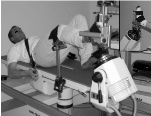
Fig. 5. Position du sujet en décubitus dorsal genou tendu pour une évaluation isocinétique des inverseurs et éverseurs du pied (d'après Edouard, et al. , 2011).
